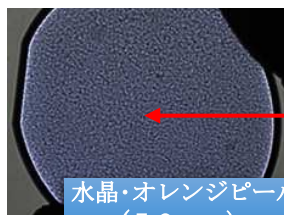
水晶 切断欠陥
